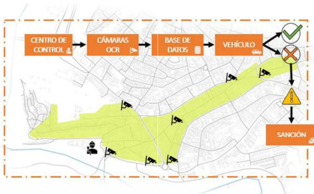
Ilustración 9-1. Sistema de control Zona de Bajas Emisiones. Fuente: Elaboración propia
